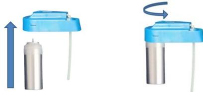
Ajuste el nuevo tanque de presión girándolo en el sentido de las agujas del reloj en el cabezal del Bluespray, mientras coloca el botón pulsador en la válvula.
